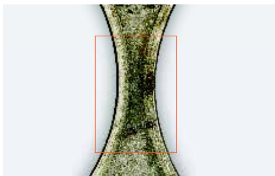
▲ Fuite de gaz avec coloration noire locale de l'anneau de la chambre de combustion.
