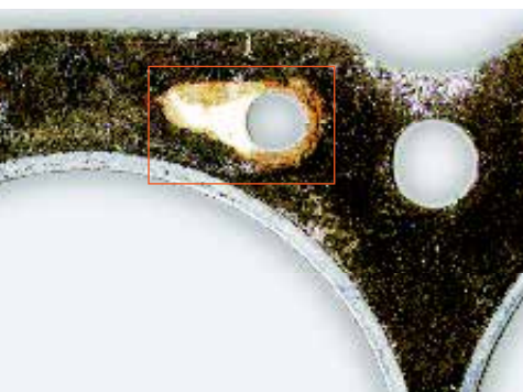
▲ Gonflements dans le cas de joints de culasse composites suite à une surchauffe avec formation de vapeur.
