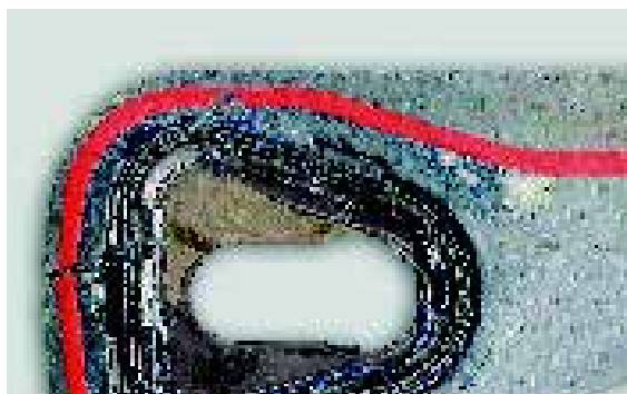
▲ Rupture ou un déchirement du matériau composite et élément Viton endommagé suite à une application non conforme de produits d'étanchéité supplémentaires.
